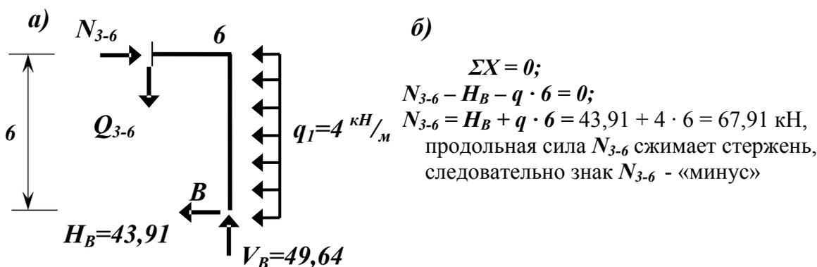
Рис. 20. Нахождение продольной силы  $N$  на участке 3-6 (а) – схема вырезанной части элемента  $CBE$ , с действующими на нее силами; б) – нахождение величины, направления и знака  $N$ )
